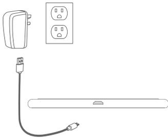
1. Utilisez le câble de charge micro USB et l'adaptateur mural Quick Charge 3.0 inclus pour brancher le tapis de charge.
